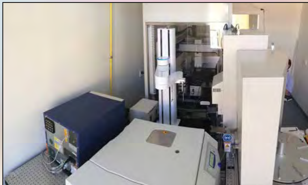
Obr. 1 Robotická ruka SCARA, která propojuje všechny komponenty systému.
