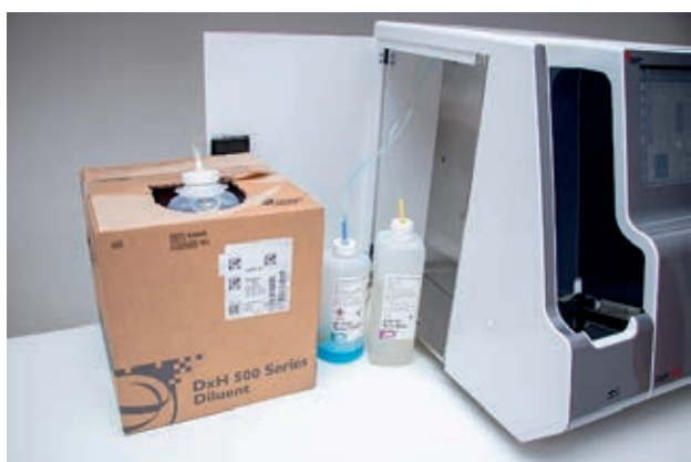
Obr. 2: DxH 560 – umístění reagentů
